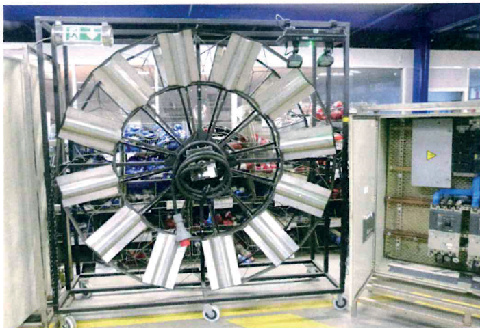
Un gros chauffage radiant, alimentable par l'armoire électrique précédente.
