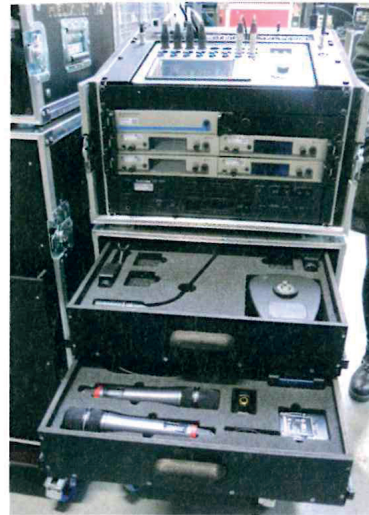
Un rack « conférence » : la console et la partie HF sont dans le demi-rack du haut, les accessoires, avec leurs découpes, dans la partie du bas.
