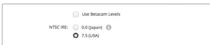
Cochez la case **Use Betacam Levels** si vous travaillez avec des magnétoscopes Betacam SP de Sony. Choisissez le niveau IRE pour le format vidéo composite NTSC.
